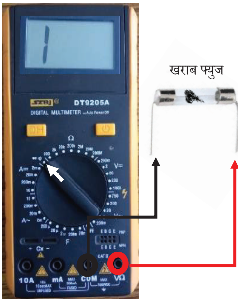
चित्र २५: जलेको फ्युजको परीक्षण गर्दा मल्टिमिटरले खुल्ला सर्किट सङ्केत गरेको अवस्था
