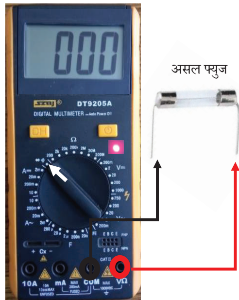
चित्र २६: असल फ्युजको परीक्षण गर्दा मल्टिमिटरले सर्ट सर्किट सङ्केत गरेको अवस्था
