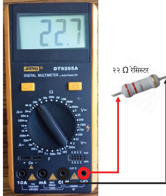
चित्र ३६: मल्टिमिटरद्वारा रेसिस्टर परीक्षण गर्ने तरिका
