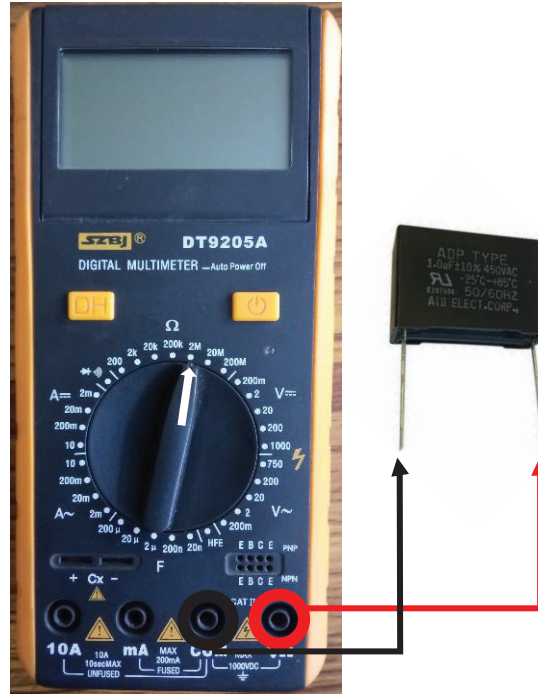
चित्र ३४: अवरोध मापन गरि क्यापासिटर परीक्षण गर्ने तरिका
