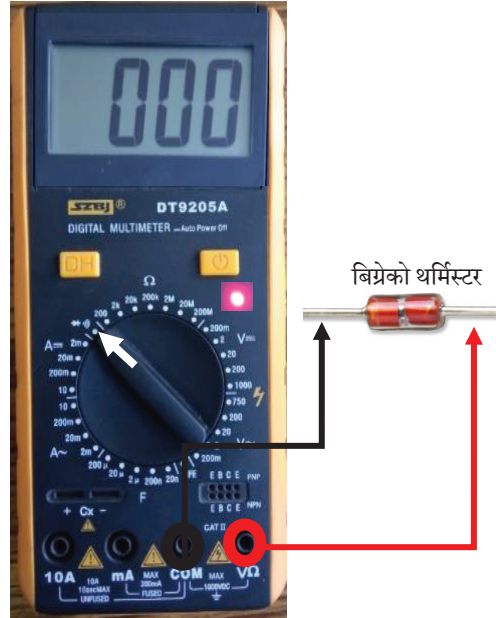
चित्र ३०: बिग्रेको थर्मिस्टर परीक्षण गर्दा निरन्तरता देखिएको
