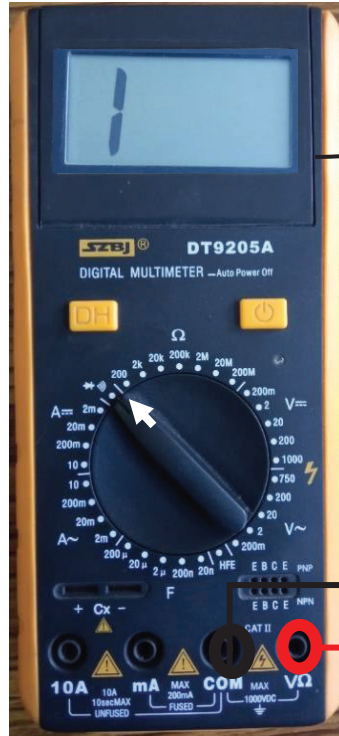
चित्र ४१ : असल जिनेर डायोडले खुल्ला सर्किट सङ्केत गरेको अवस्था
