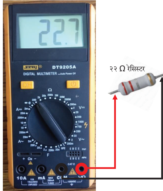
चित्र ४६: मल्टिमिटरद्वारा रेसिस्टर परीक्षण गर्ने तरिका
