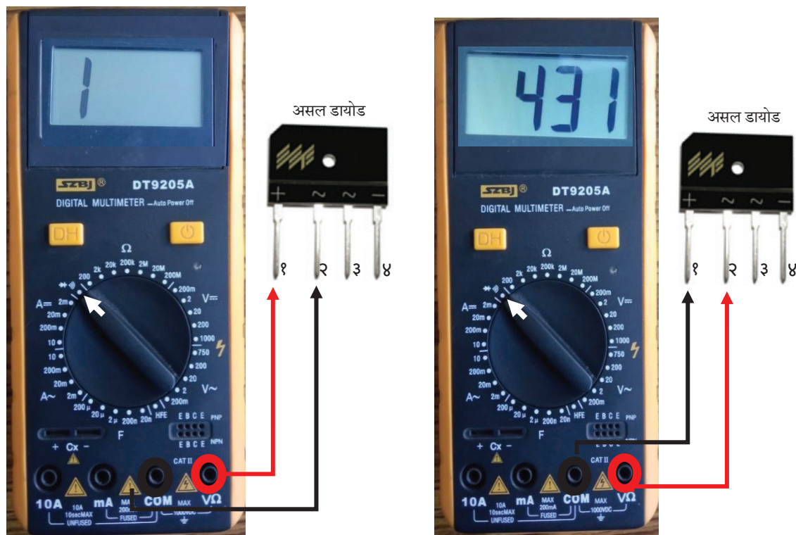
चित्र ४०: DC र AC पिन प्रयोग गरि रेक्टिफायरको परीक्षण
