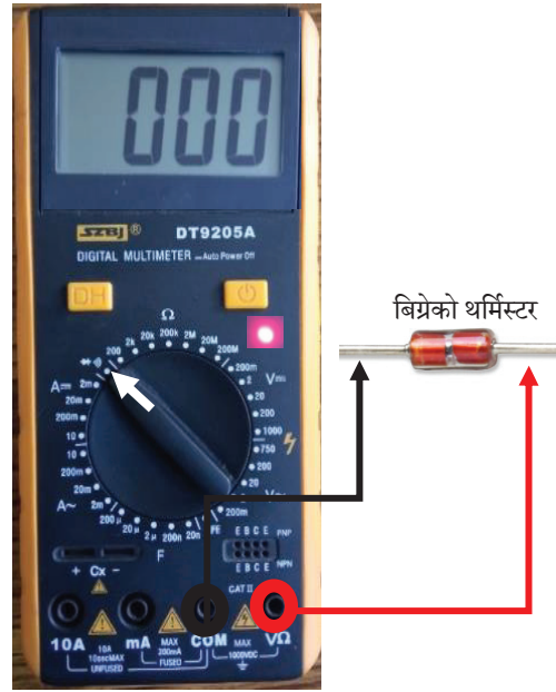
चित्र ४७: बिग्रेको थर्मिस्टर परीक्षण गर्दा निरन्तरता देखिएको
