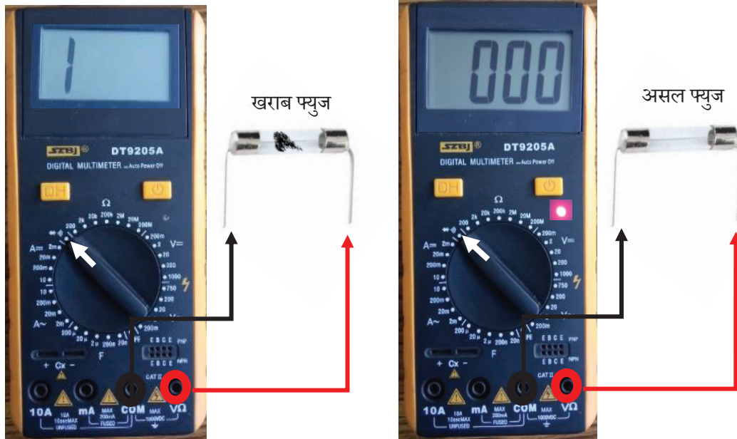
चित्र ३२: जलेको फ्युजको परीक्षण गर्दा मल्टिमिटरले खुल्ला सर्किट सङ्केत गरेको अवस्था
